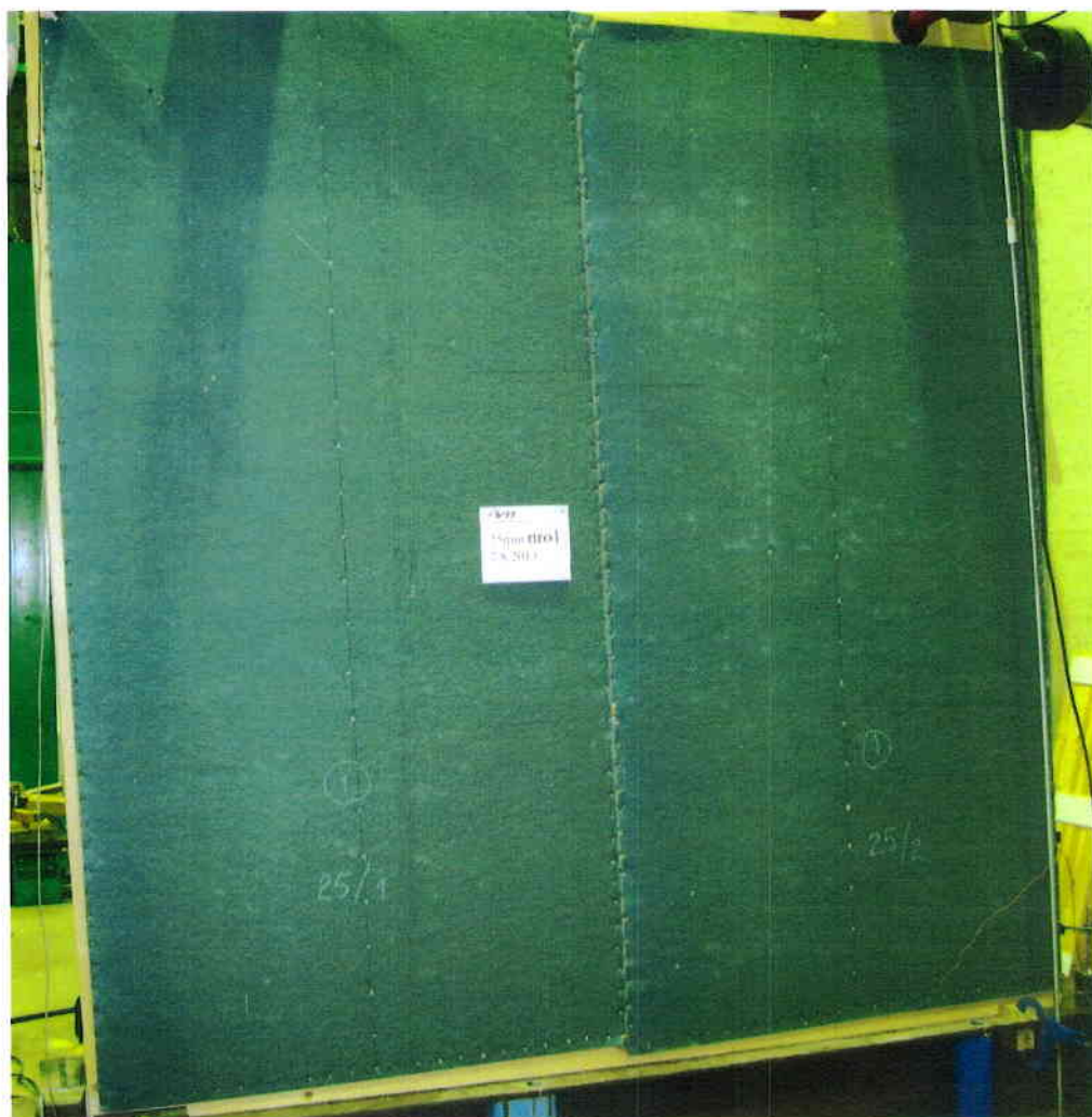
Kuva 8 Murtotapa Runkoleijonalevyn jäykistysseinäkokeissa, yleiskuva.
