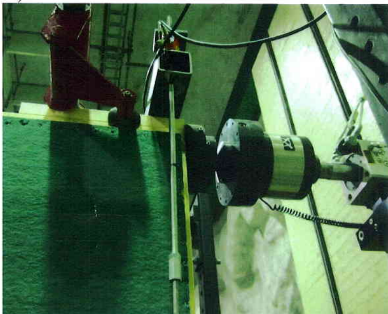
Kuva 4 a) Seinän ylänurkan kuormitus- ja tuentajärjestelyt ja b) seinän alanurkan pystysiirtymän mittaajajärjestely.
