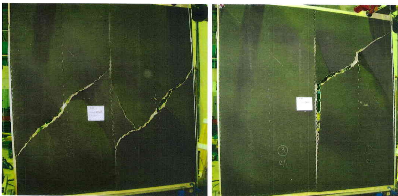
Kuva 6 Murtotapa Tuulileijonalevyn jäykistysseinäkokeissa.
